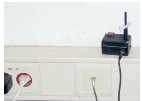
Abb. 1: a) Temperatursensor (LM35 National Semiconductor) [7] und Chipcon CC1010 Modul [6], b) entwickelter Temperatur-Sensorknoten und c) Temperatur-Sensorknoten im Einsatz
