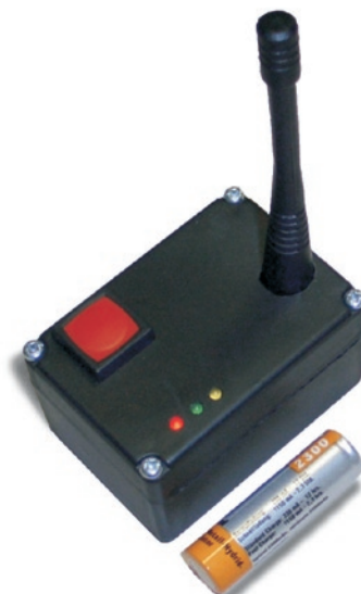
Abb. 1: a) Temperatursensor (LM35 National Semiconductor) [7] und Chipcon CC1010 Modul [6], b) entwickelter Temperatur-Sensorknoten und c) Temperatur-Sensorknoten im Einsatz
